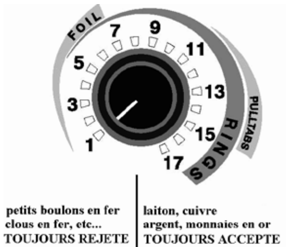
Figure 8 - Exemples de réglages de Discrimination
