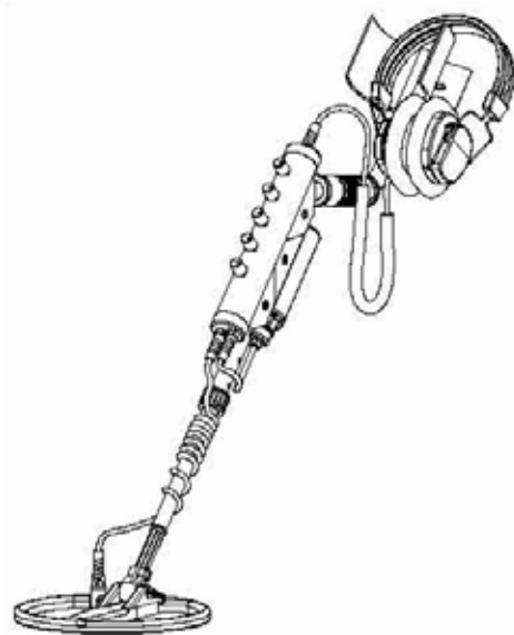
Figure 4 - Excalibur avec sa canne assemblée en mode "Plongée"
